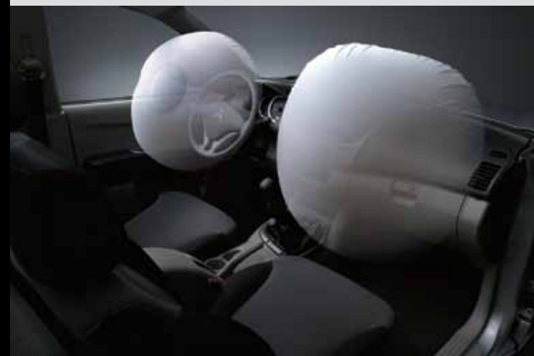
Túi khí đôi an toàn và chức năng căng đai tự động (pre-tensioner) cho hàng ghế trước
